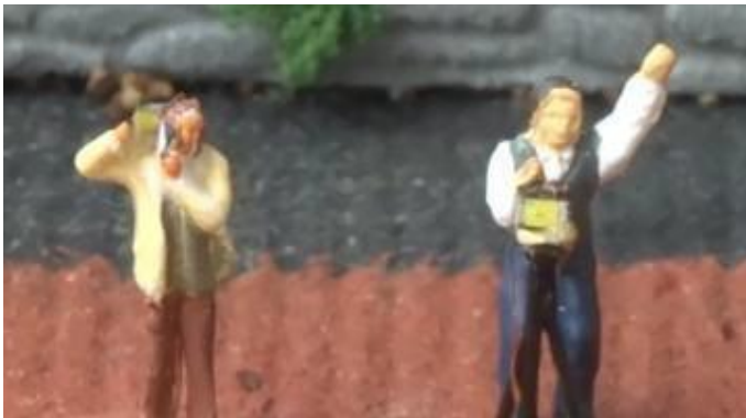
De micro LED's zitten hier gemonteerd op de fotografen, de aansluitdraden zijn naar achter de fotografen gebogen en door de modelbaan gestoken en aangesloten op de Arduino processor.
